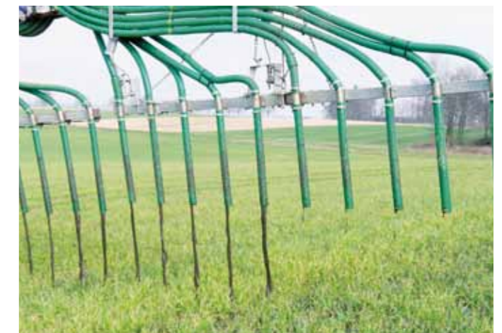
Arbeitsbreitenreduktion mit CFC (Schläuche sind zur Verdeutlichung angehoben)
